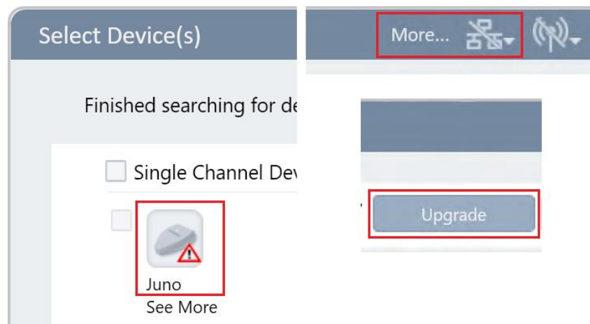
Abbildung 109: StarLab Geräteauswahl mit Fehler (links); Upgrading (rechts)
